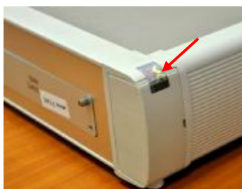
Рисунок 2а - Место для пломбировки от несанкционированного доступа
