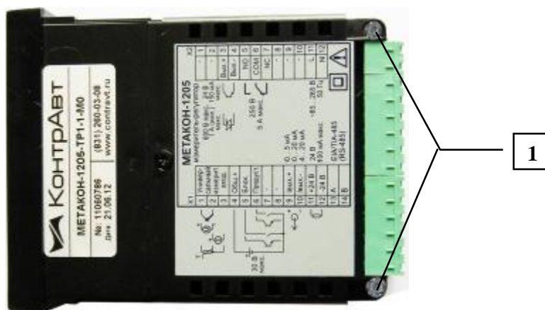
Рисунок 3 – Защита приборов МЕТАКОН серии XXXX от несанкционированного вскрытия с помощью поверительного клейма
