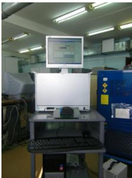
Рис. 1. Общий вид установок для измерений электрических параметров аналоговых и аналого-цифровых ИС «Вектор-4».
