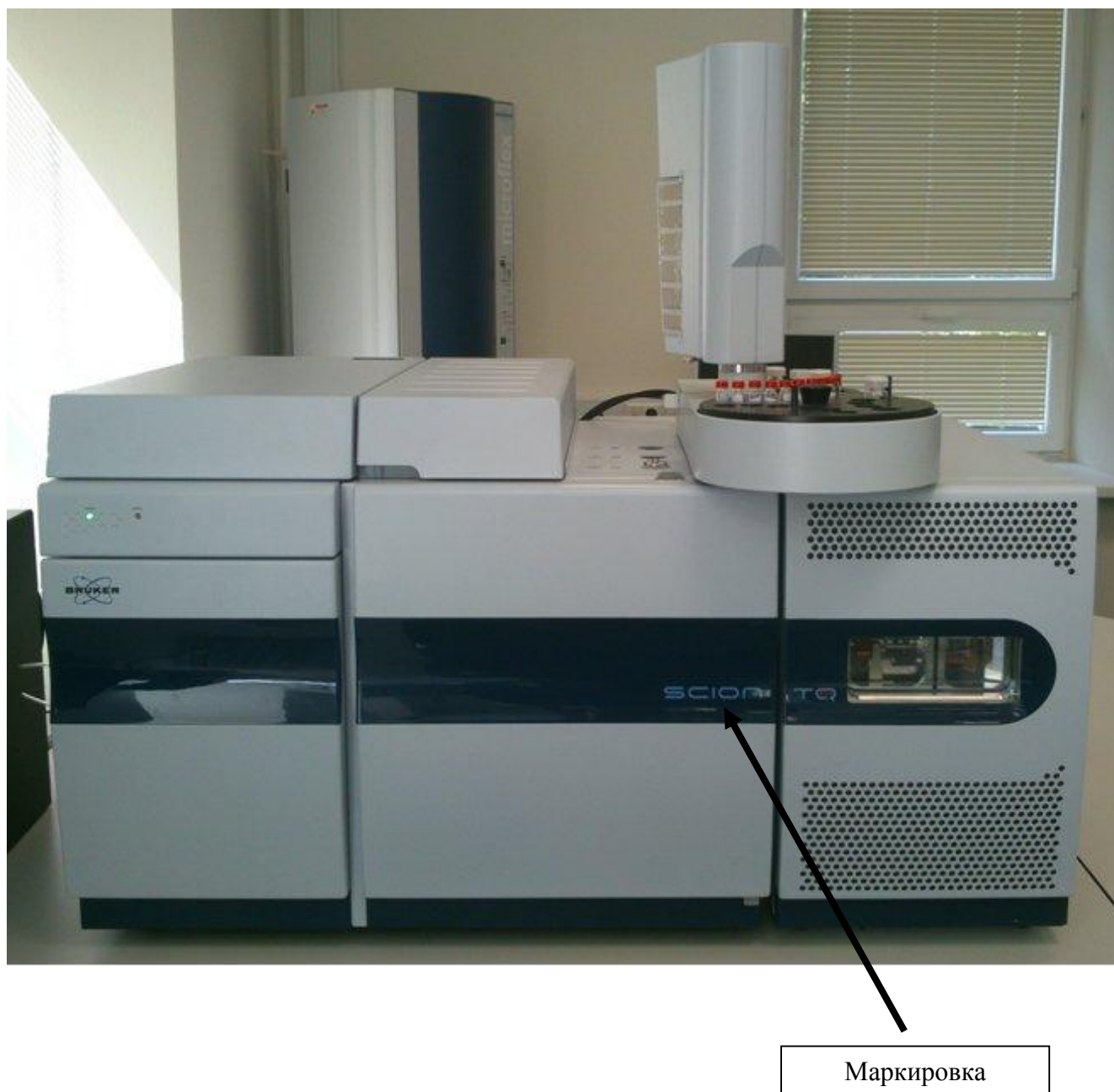
Рисунок 1 - Общий вид хромато-масс-спектрометра SCION модели TQ с обозначением мест нанесения маркировки
