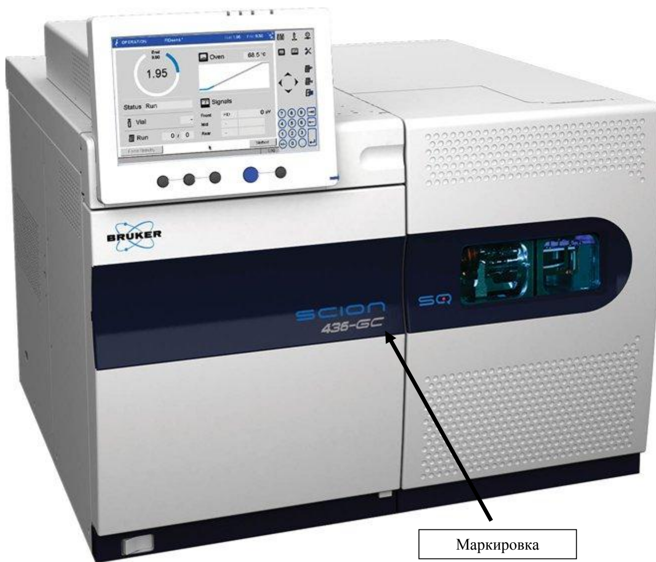
Рисунок 2 - Общий вид хромато-масс-спектрометра SCION модели SQ Premium с обозначением мест нанесения маркировки
