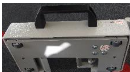
Рисунок 2 - Схема пломбирования от несанкционированного доступа весоизмерительного датчика.
