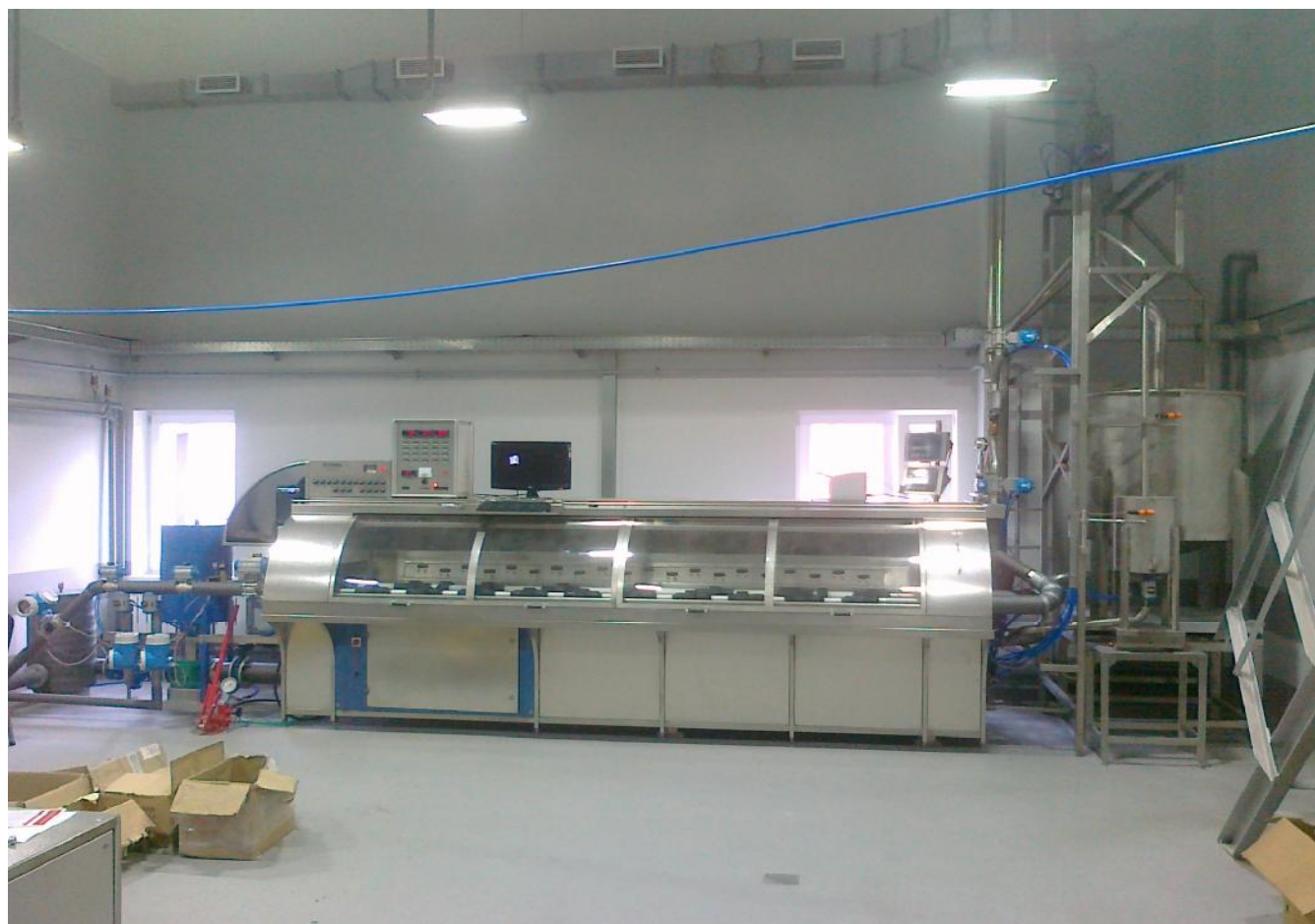
Рисунок 1 – Общий вид установки поверочной ППУ-Х 1550.2
