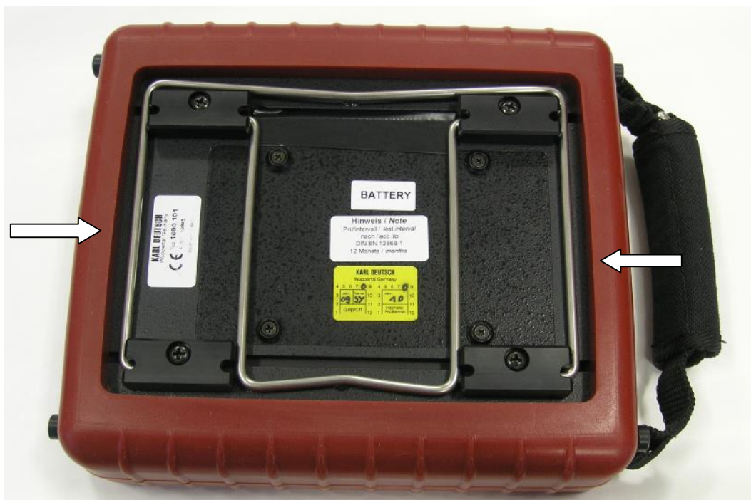
Рисунок 2 – Место пломбировки корпуса дефектоскопа
