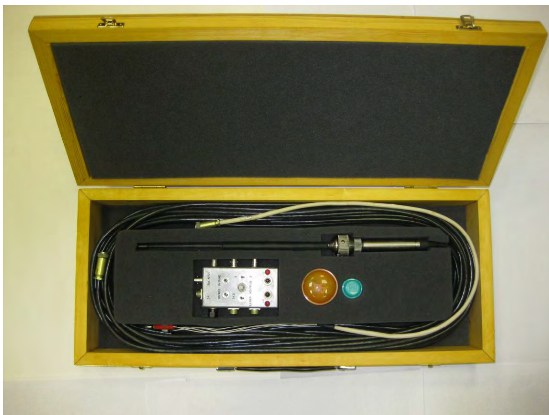
Фотография общего вида гидрофона ГИ800
