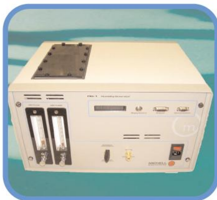
Рисунок 1. Внешний вид генератора влажного газа Michell Instruments модификации HG-1.
