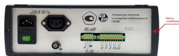
Рисунок 3 - Места пломбировки аппаратуры СКИВ
