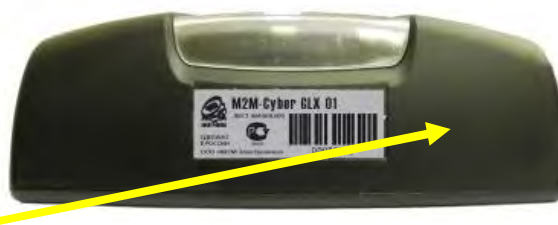
Рисунок 2 - Место нанесения знака об утверждении типа
