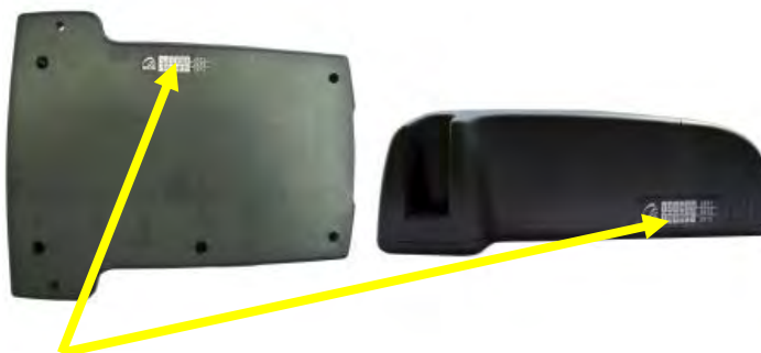
Рисунок 3 - Места защитных пломб
