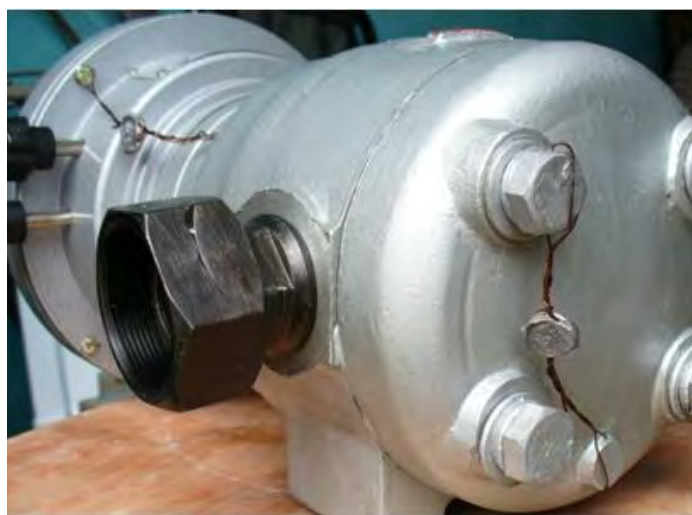
Фото 2 - Схема пломбировки счетчика от несанкционированного доступа
