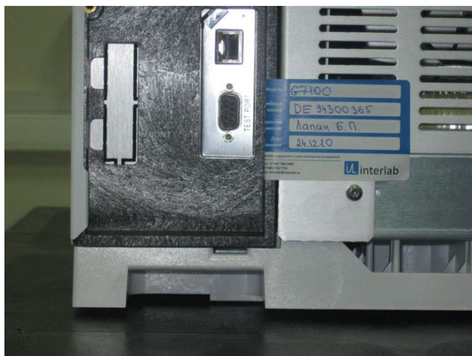
Рисунок 2. Место пломбирования для защиты от несанкционированного доступа
