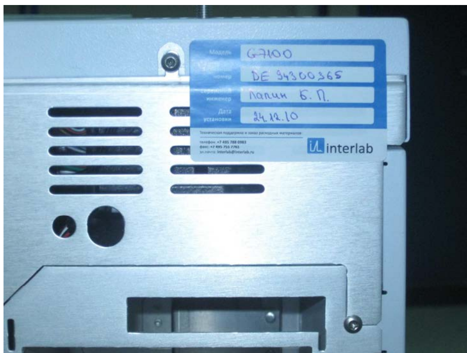
Рисунок 1. Место пломбирования для защиты от несанкционированного доступа
