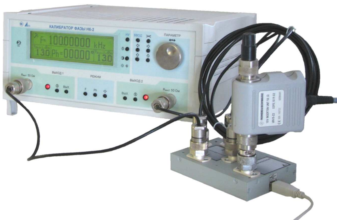
Рисунок 1 - Калибратор фазы Н6-2 с мостом измерительным МЕРА. 411625.006
