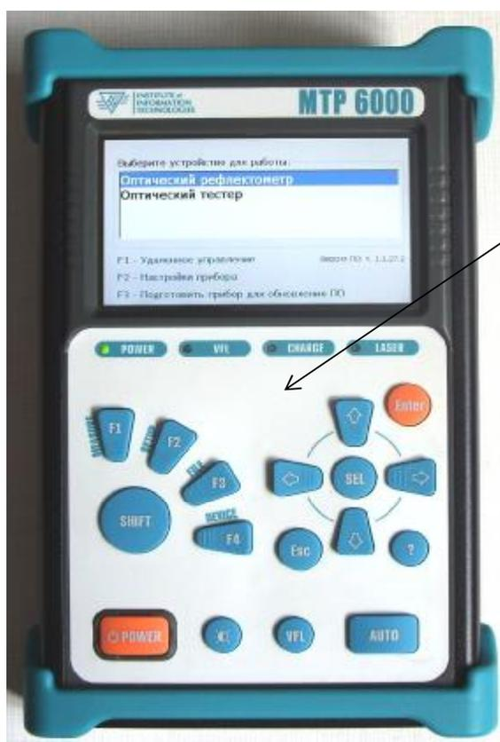
Место нанесения знака поверки в виде клейма-наклейки
