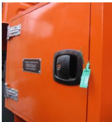
Рисунок 6 – Отсек для размещения узла выдачи топлива АТЗ
