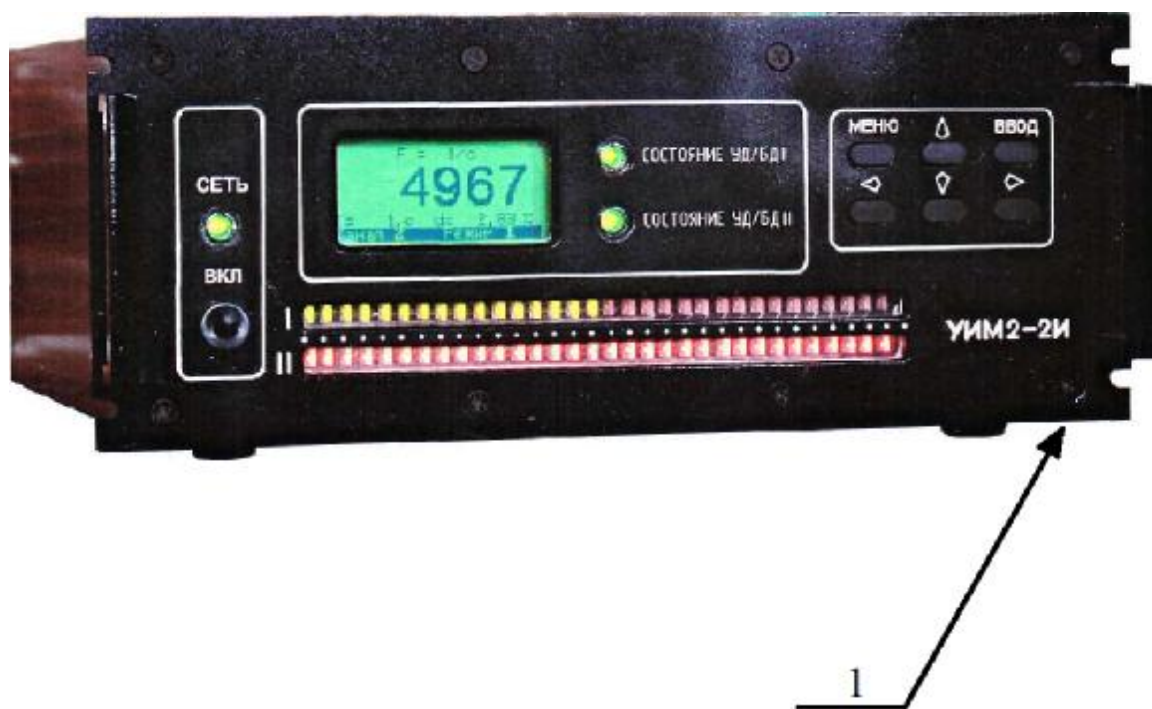
1 – Пломбы с оттиском клейма поверителя Рисунок 1 – Общий вид измерителя средней скорости счёта УИМ2-2И
