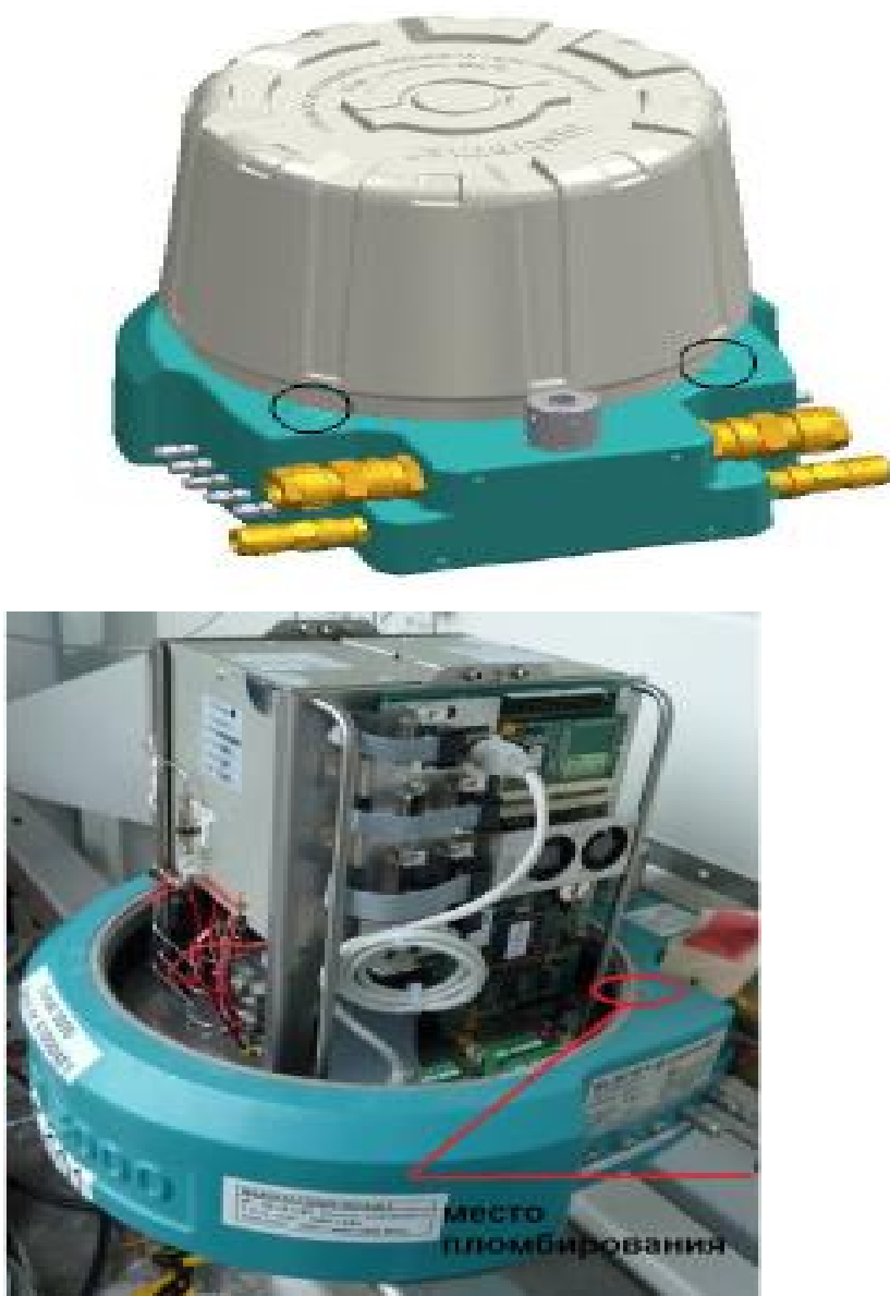
Рисунок 1 – Общий вид хроматографов Encal 3000 с указанием мест пломбирования
