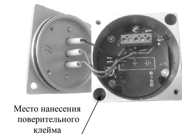
Рисунок 5 – Место нанесения поверительного клейма на преобразователи АСТРА-ЭП-1ХХ-Х и АСТРА-ЭП-2ХХ-Х
