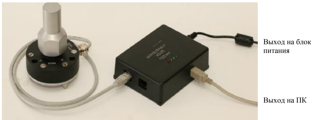
Рисунок 1. Внешний вид измерителя угла наклона двухкоординатного ИН-ДЗ с цифровым выходом
