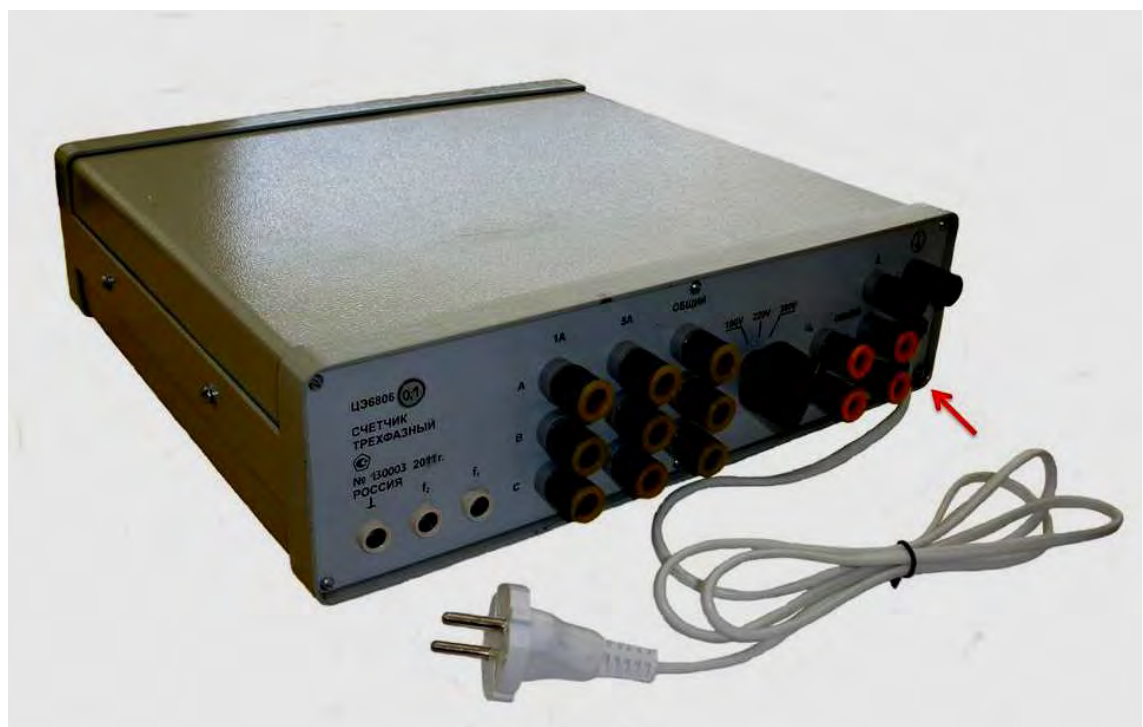
Фото 2 – Общий вид счетчика со стороны задней панели и место пломбирования на задней панели
