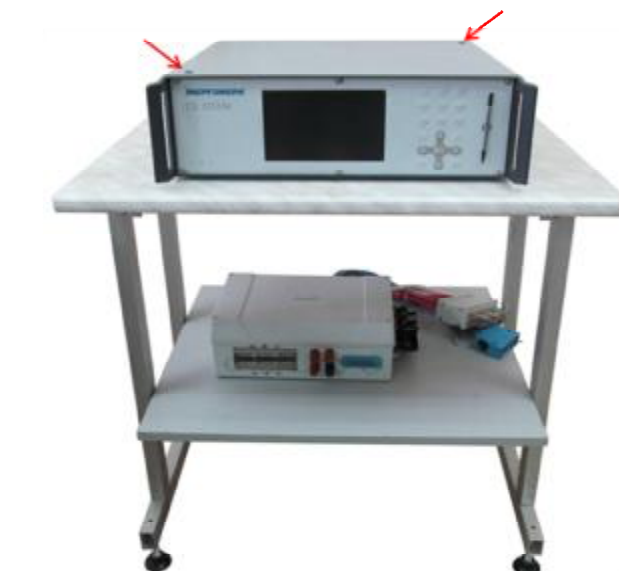
Рисунок 3 - Общий вид стойки эталонного счетчика установок исполнений ЦУ6800М-Р, ЦУ6800МИ, ЦУ6800МИ-Р, ЦУ6800М-Т, ЦУ6800МИ-Т и места пломбирования эталонного multifunctional wattmeter-counter SE603M on the top panel
